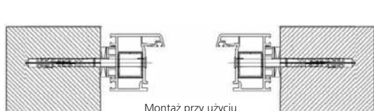
Montaż przy użyciu dybli rurowych
