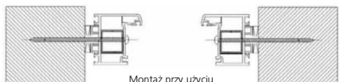
Montaż przy użyciu śrub samogwintujących
