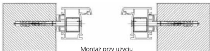
Montaż przy użyciu dybli rurowych
