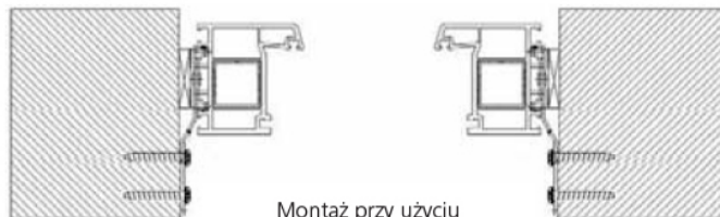
Montaż przy użyciu kotew montażowych
